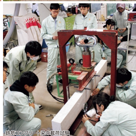
鉄筋コンクリート梁の載荷試験
