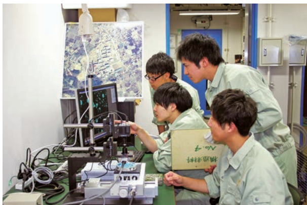
コンクリート断面の空気泡測定
