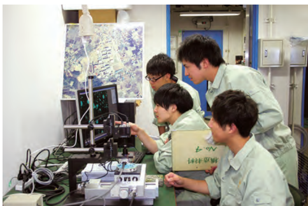
コンクリート断面の空気泡測定
