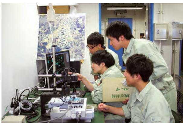
コンクリート断面の空気泡測定
