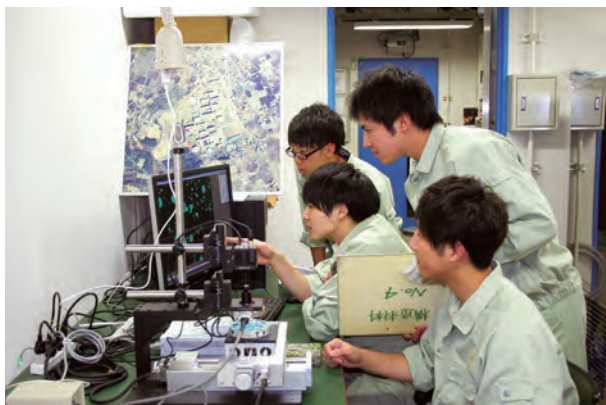
コンクリート断面の空気泡測定
