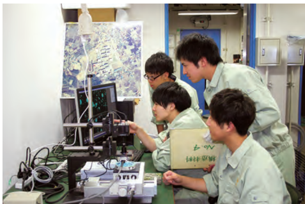
コンクリート断面の空気泡測定
