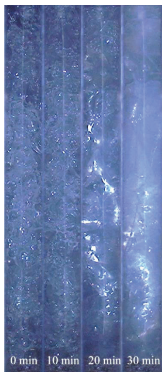
図 1 2 ポリスチレン-有機修飾シリカナノ粒子系における相状態の経時変化 (左から 0、10、20、30 分)
